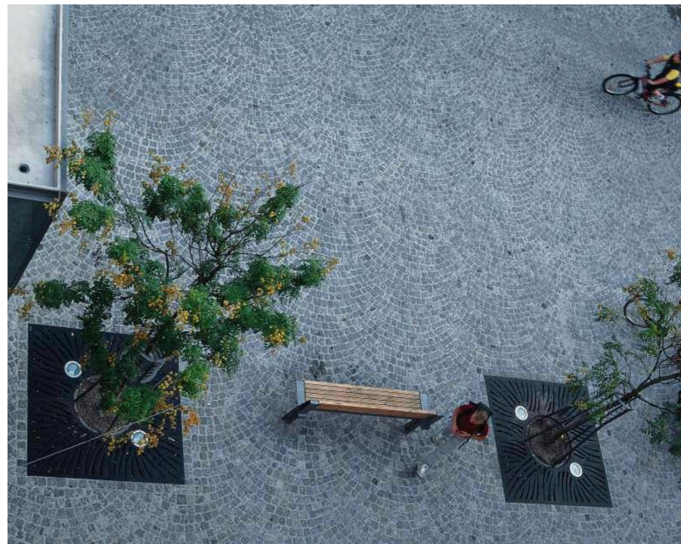
Puun maaritilä, johon on integroitu valaisin. Kuva: Hess
